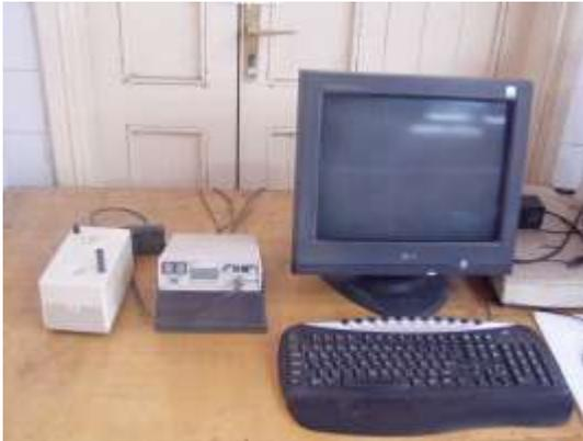
جهاز قياس الحساسية المغناطيسية بالصخور
